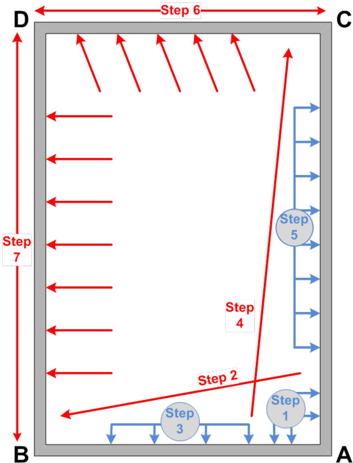
Figura 2: Diagrama de estiramiento para alfombra felpada. En ausencia de las recomendaciones del estiramiento del fabricante de la alfombra, utilice este diagrama.
